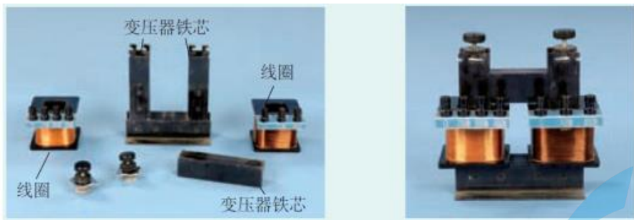
甲 可拆变压器零部件 乙 组装后的变压器
