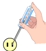
D. 用试电笔辨别火线和零线
