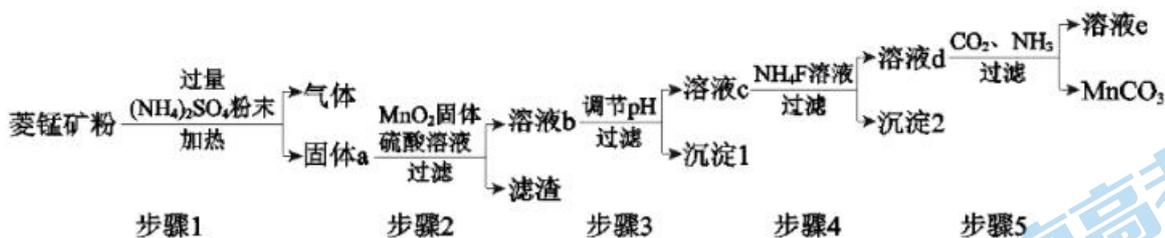
I. 金属碳酸盐和硫酸铵混合粉末在加热条件下反应，生成硫酸盐、 $\text{NH}_3$  和  $\text{CO}_2$ 。
