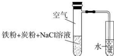
一段时间后, 试管发热, 导管口有气泡产生
