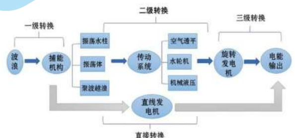
图 17 波浪能发电的三级转换
