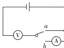
(2) 单刀双掷开关与  $a$  接通时,电压表读数为  $U_1$ ;单刀双掷开关与  $b$  接通时,电压表读数为  $U_2$ ,电流表读数为  $I$ (3 分)
