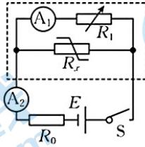
(2) 由实验原理可知, 电流表①和  $R_1$  串联后和  $R_x$  并联, 根据欧姆定律得  $R_x = \frac{I_1(r_1 + R_1)}{I_2 - I_1}$ ,
